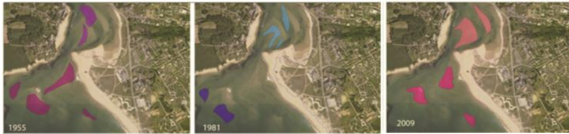
Figure 3. Evolution des bancs sableux sur les deltas de flot et de jusant de l'embouchure de La Laïta, entre 1955 et 2009 (source : M. SEDRATI et G. BULOT, 2015, extrait).
