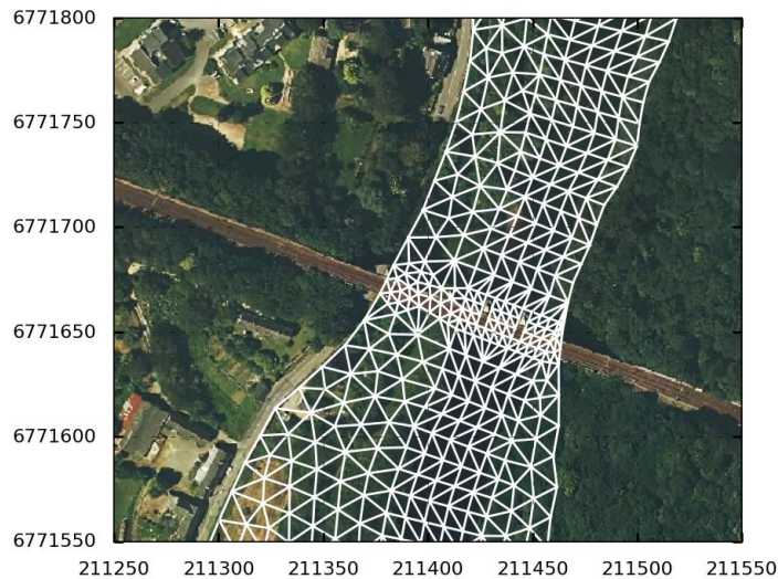
Figure 14 : Représentation du maillage au niveau du pont ferroviaire (fond de carte BD ORTHO®).
